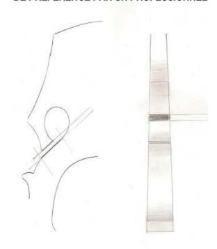
Il faudra veillez tout particulierement au parallèlisme des surfaces en contact. Le capteur doit, lors de son placement, forcer SUFFISAMMENT. Attention à ne pas casser l'oreillette, Si le capteur est trop lâche et ne force pas assez, on pourra alors le câler avec un petit morceau de bois (ou de carton) qui sera placé sur sa partie supérieure.
