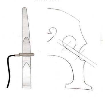
Il faudra veillez tout particulierement au parallélisme des surfaces en contact. Le capteur doit, lors de son placement, forcer SUFFISAMMENT. Attention à ne pas casser l'oreillette, Si le capteur est trop lâche et ne force pas assez, on pourra alors le câler avec un petit morceau de bois (ou de carton) qui sera placé sur sa partie supérieure.
